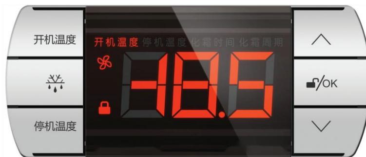
显示板可以显示三个数字，两个状态指示符（按键锁、风机），四个参数描述字（开机温度、停机温度、化霜周期、化霜时间）。
